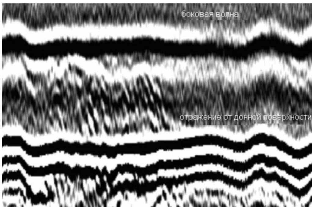
Рисунок Г.3 – TOFD-изображение при установлении слишком низкого усиления
